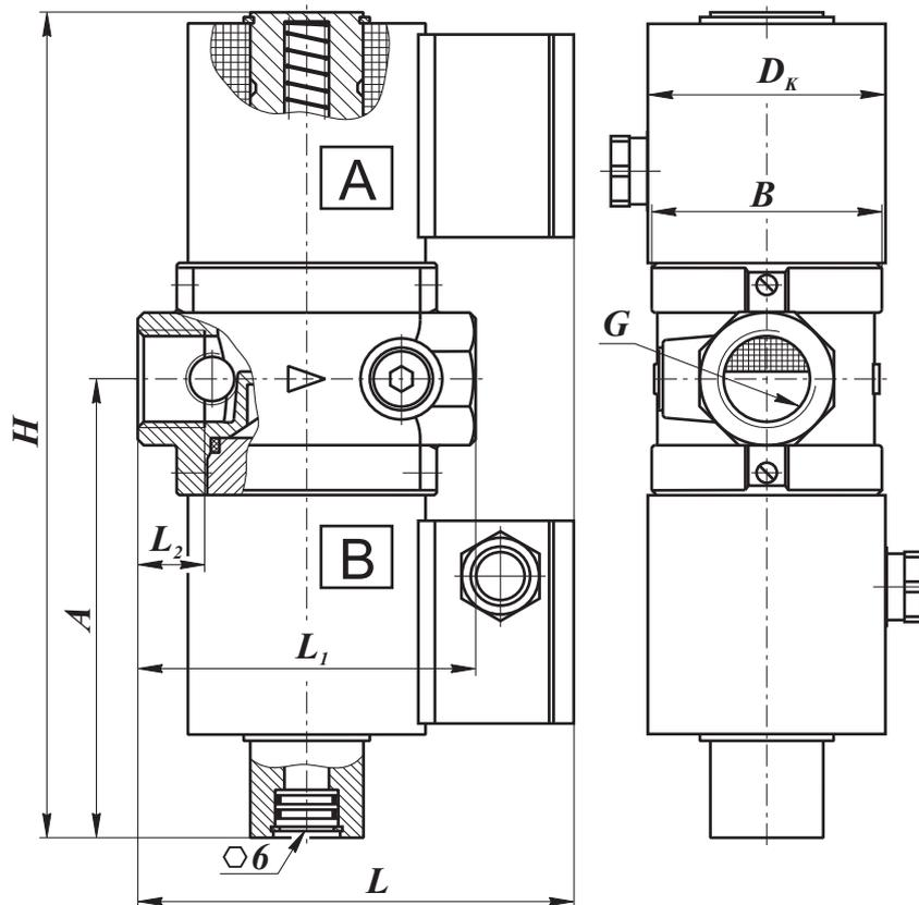
Рис. 3-1. Клапаны трехпозиционные муфтовые на Ду20, 25 с одним регулятором расхода
