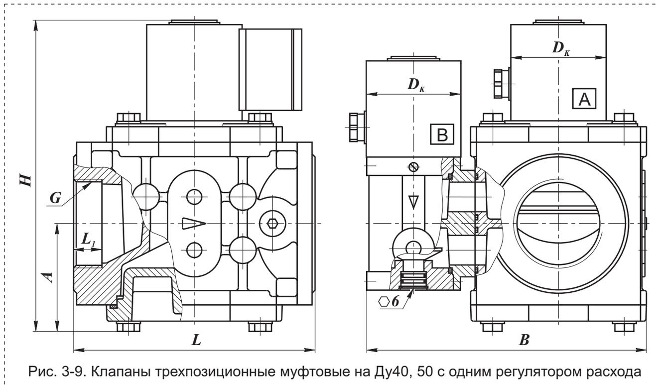
Рис. 3-9. Клапаны трехпозиционные муфтовые на Ду40, 50 с одним регулятором расхода
