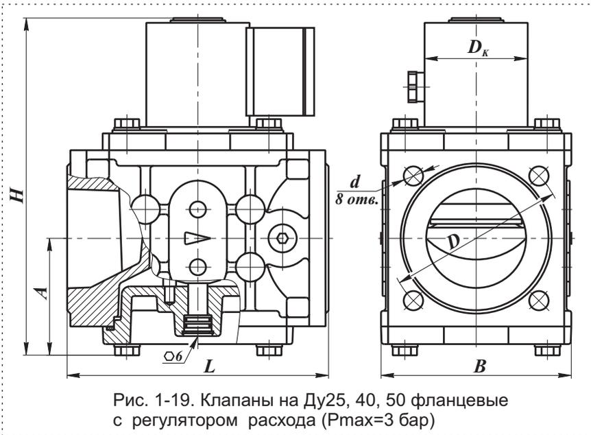
Рис. 1-19. Клапаны на Ду25, 40, 50 фланцевые с регулятором расхода (Pmax=3 бар)
