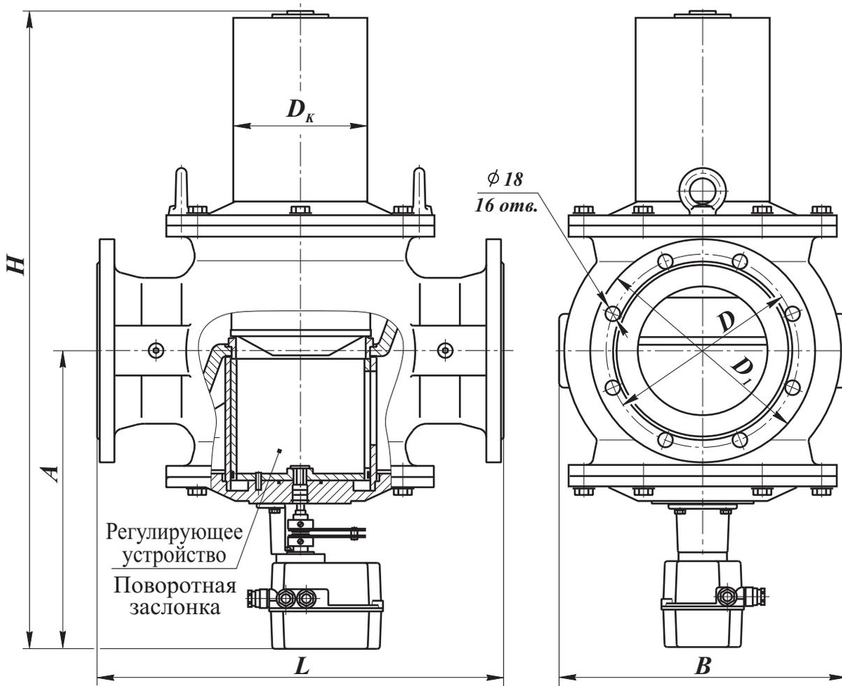
Рис. 7-6. Клапаны на Ду 150, 200 фланцевые с электромеханическим регулятором расхода (пропорциональное регулирование, привод SP0)
