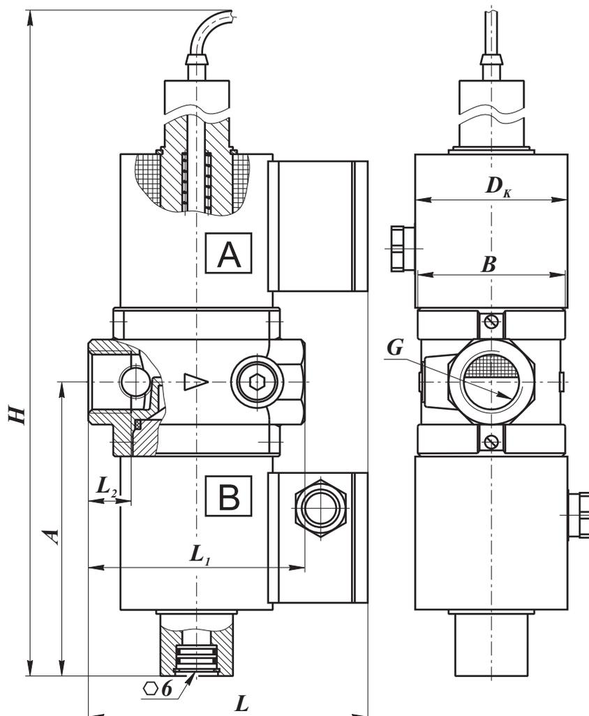
Рис. 3-2. Клапаны трехпозиционные муфтовые на Ду20, 25 с одним регулятором расхода и датчиком положения
