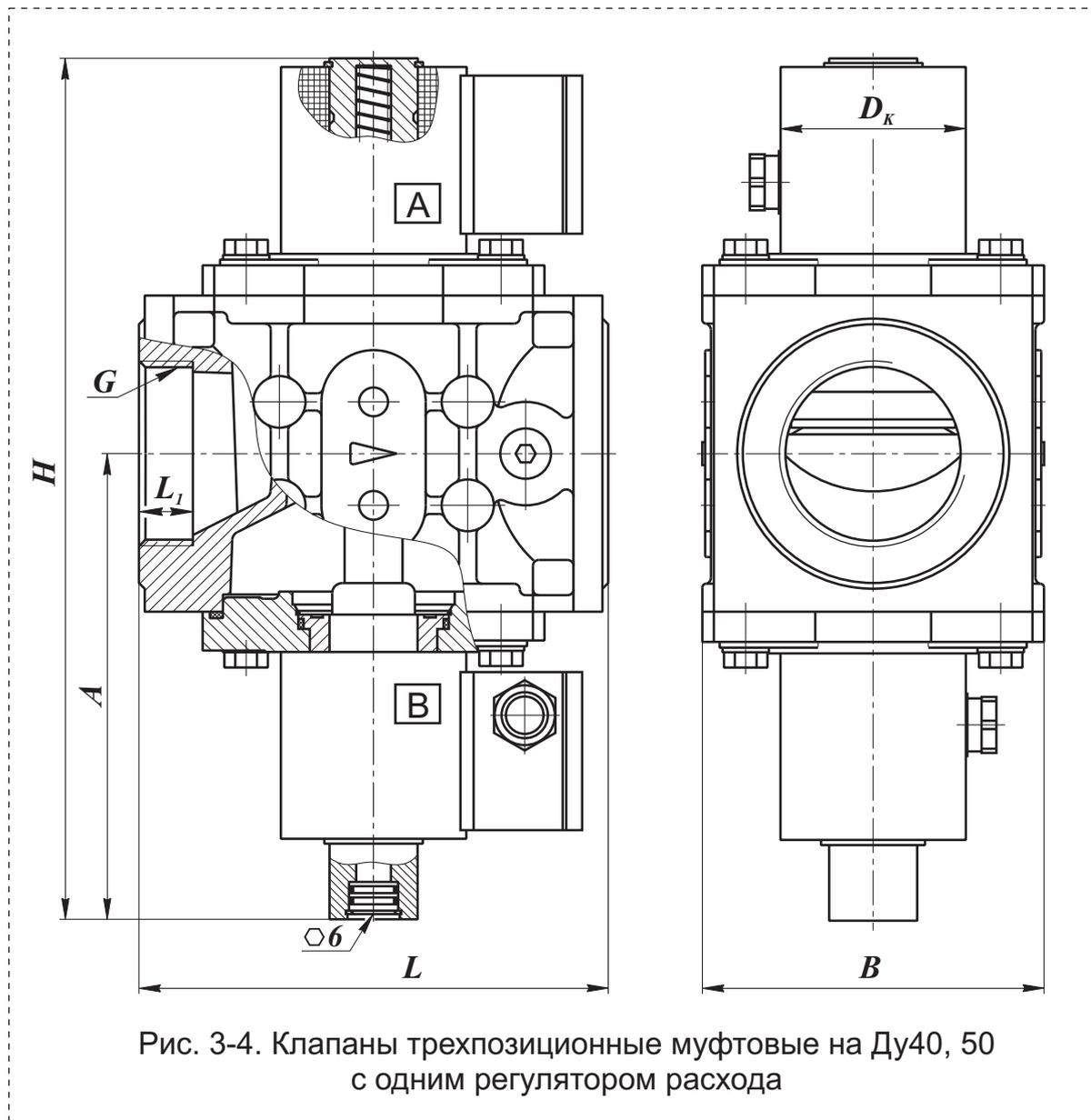
Рис. 3-4. Клапаны трехпозиционные муфтовые на Ду40, 50 с одним регулятором расхода
