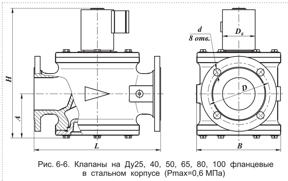
Рис. 6-6. Клапаны на Ду25, 40, 50, 65, 80, 100 фланцевые в стальном корпусе (Pmax=0,6 МПа)
