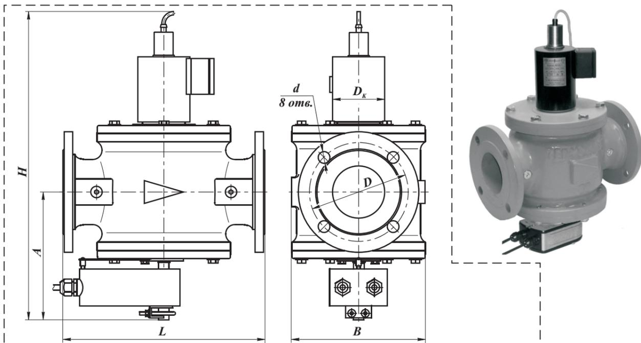
Рис. 7-13. Клапаны на Ду40, 50, 65, 80, 100 фланцевые в стальном корпусе с электромеханическим регулятором расхода и датчиком положения (позиционное регулирование, привод LF230S)
