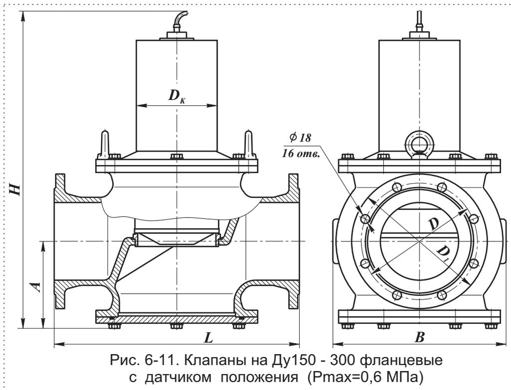
Рис. 6-11. Клапаны на Ду150 - 300 фланцевые с датчиком положения (Рmax=0,6 МПа)
