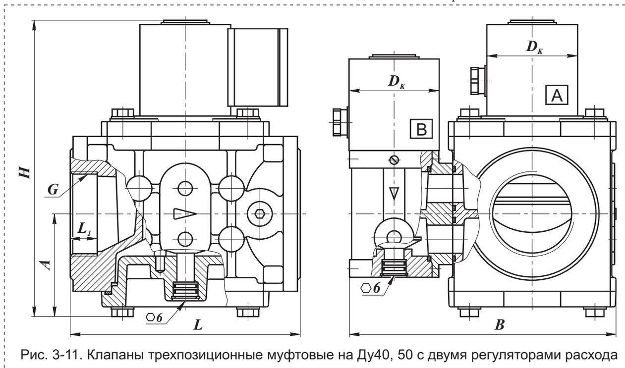
Рис. 3-11. Клапаны трехпозиционные муфтовые на Ду40, 50 с двумя регуляторами расхода
