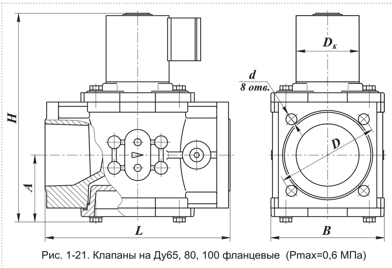
Рис. 1-21. Клапаны на Ду65, 80, 100 фланцевые ( $P_{max}=0,6$  МПа)
