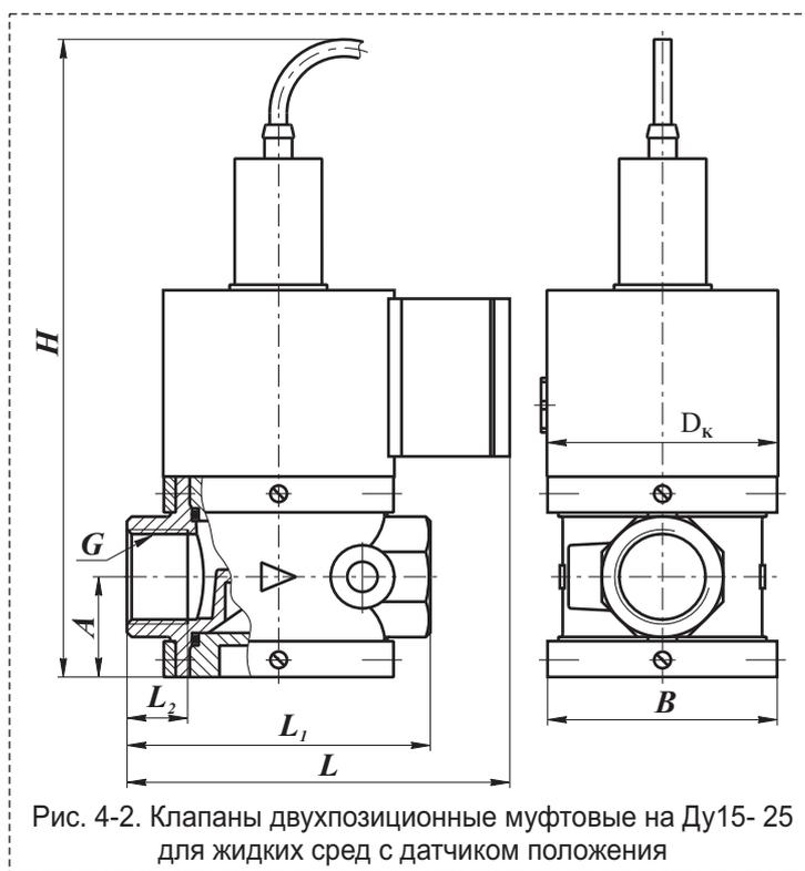
Рис. 4-2. Клапаны двухпозиционные муфтовые на Ду15- 25 для жидких сред с датчиком положения
