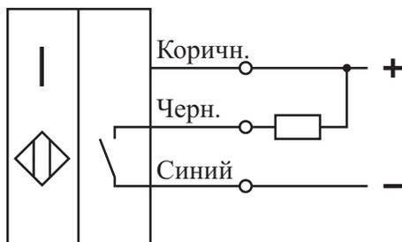
*Схема подключения индуктивной нагрузки*
