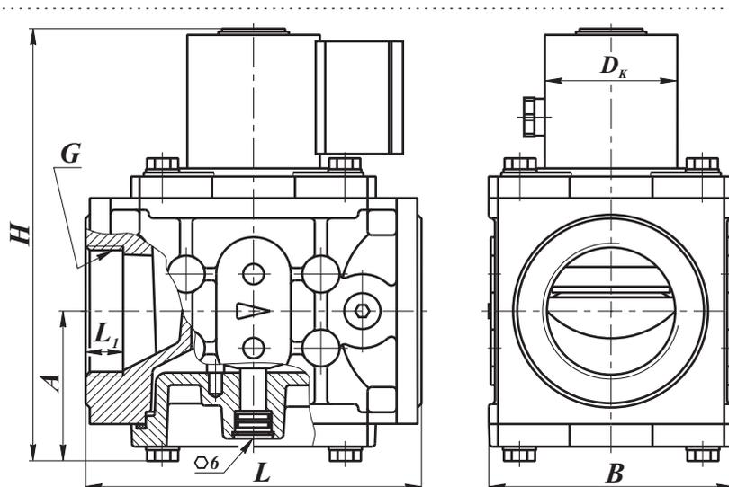
Рис. 1-15. Клапаны на Ду40, 50 муфтовые с ручным регулятором расхода (Pmax=0,3 МПа)
