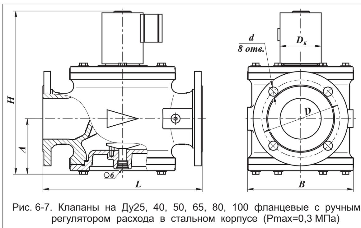
Рис. 6-7. Клапаны на Ду25, 40, 50, 65, 80, 100 фланцевые с ручным регулятором расхода в стальном корпусе (Pmax=0,3 МПа)
