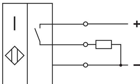
*Схема подключения индуктивной нагрузки*
