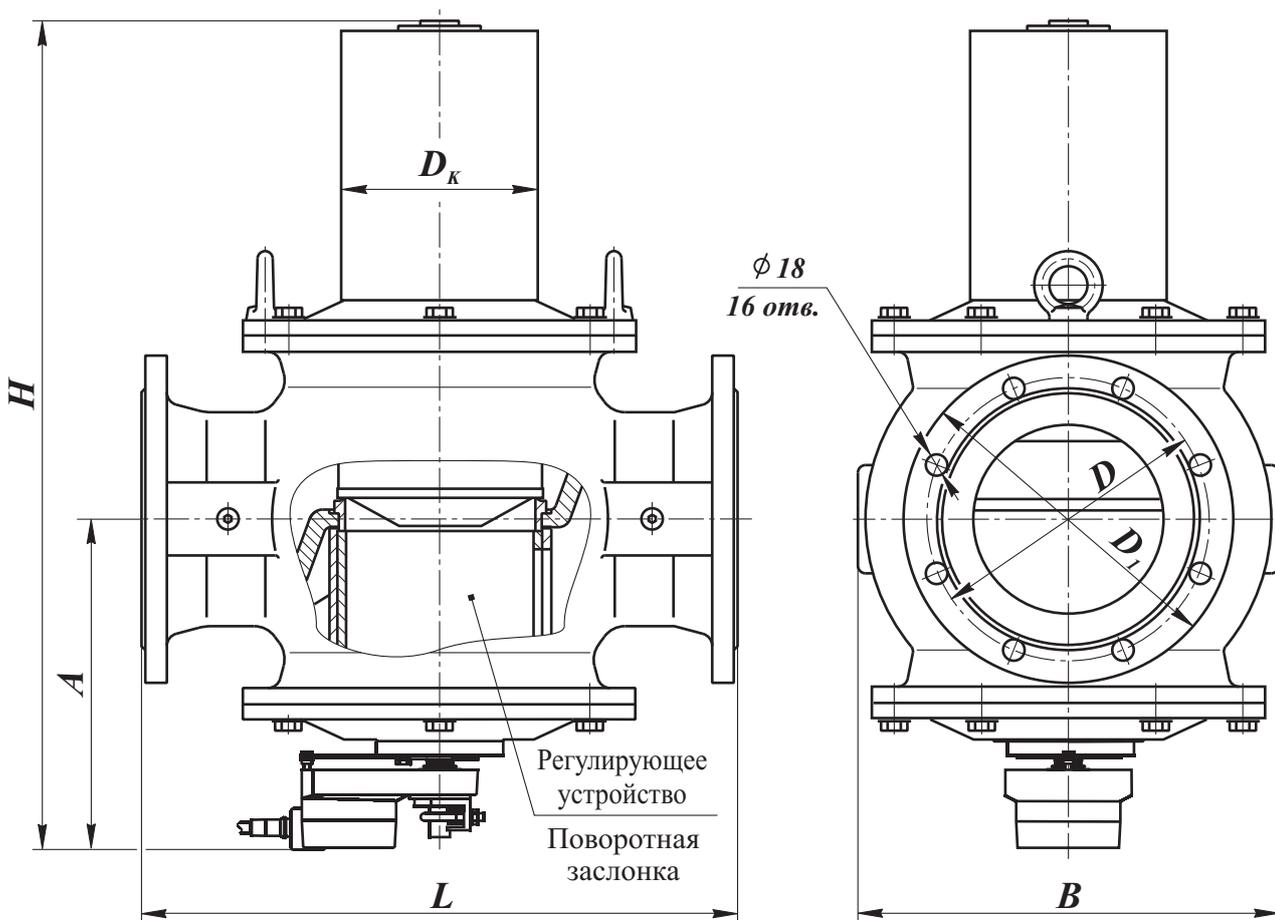
Рис. 7-10. Клапаны на Ду 150, 200 фланцевые с электромеханическим регулятором расхода (пропорциональное регулирование, привод SM24SR)
