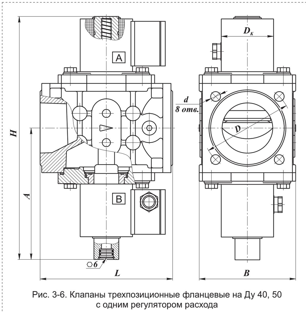
Рис. 3-6. Клапаны трехпозиционные фланцевые на Ду 40, 50 с одним регулятором расхода
