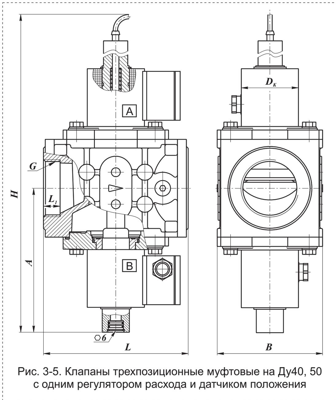
Рис. 3-5. Клапаны трехпозиционные муфтовые на Ду40, 50 с одним регулятором расхода и датчиком положения
