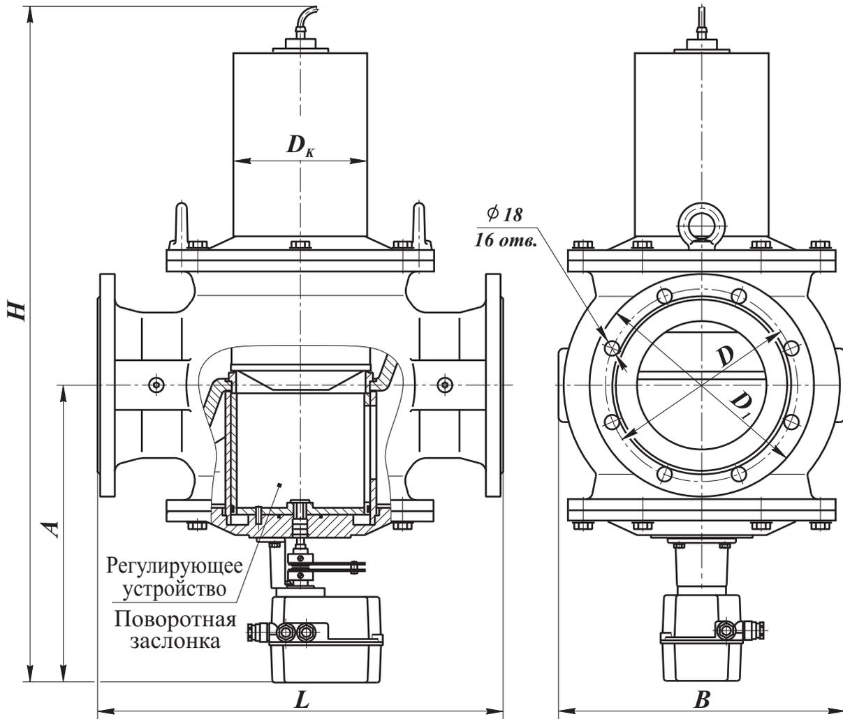
Рис. 7-7. Клапаны на Ду 150, 200 фланцевые с электромеханическим регулятором расхода и датчиком положения (пропорциональное регулирование, привод SP0)
