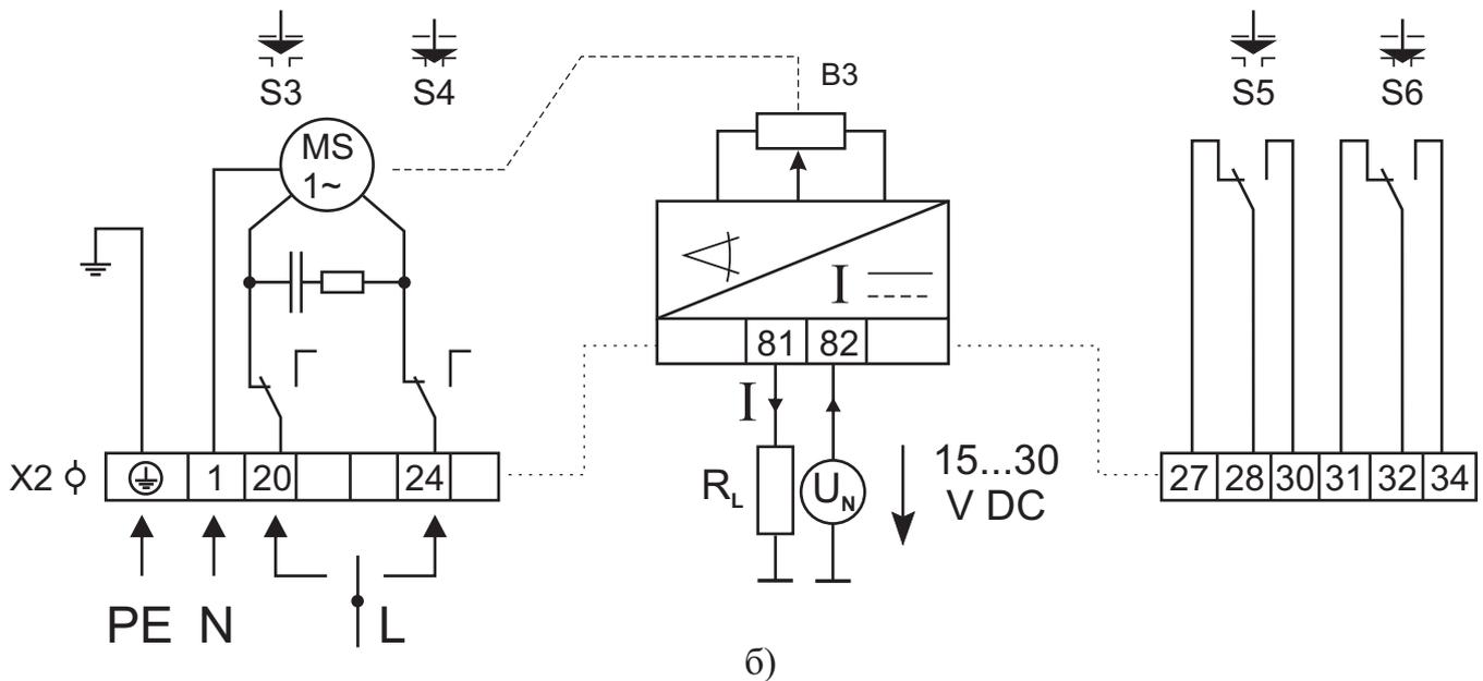
Рис. 7-1. Схема электрических соединений для электроприводов SP0 (Словакия):
