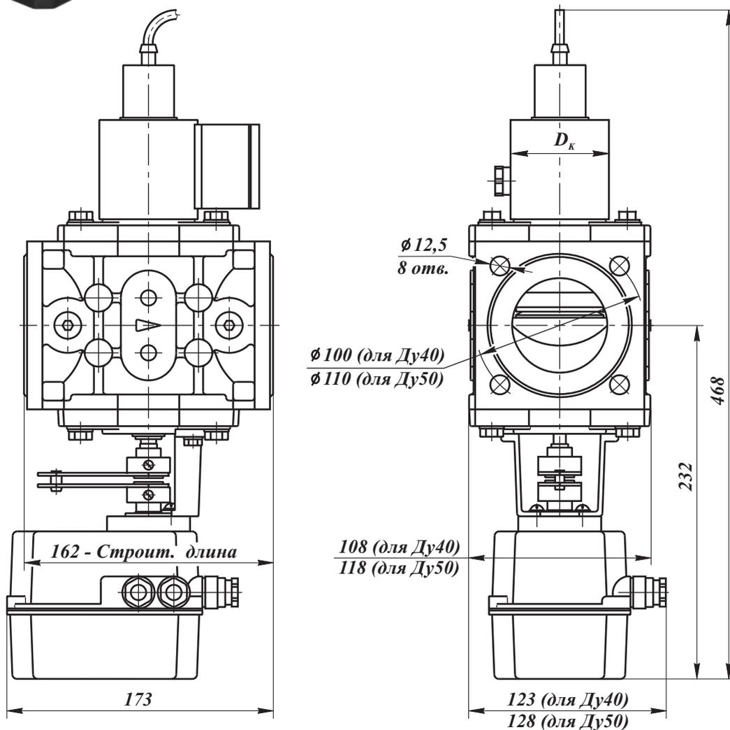
Рис. 2-7. Клапаны на Ду40, 50 фланцевые с электромеханическим регулятором расхода и датчиком положения (пропорциональное регулирование)
