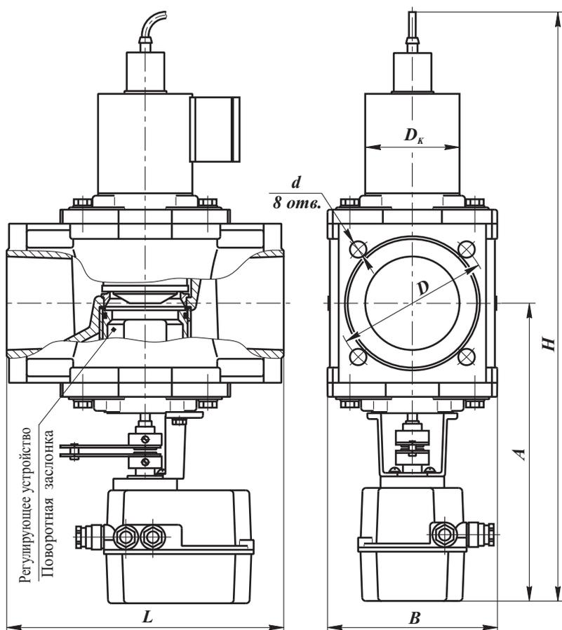
Рис. 2-9. Клапаны на Ду65, 80, 100 фланцевые с электромеханическим регулятором расхода и датчиком положения (пропорциональное регулирование, привод SP0)
