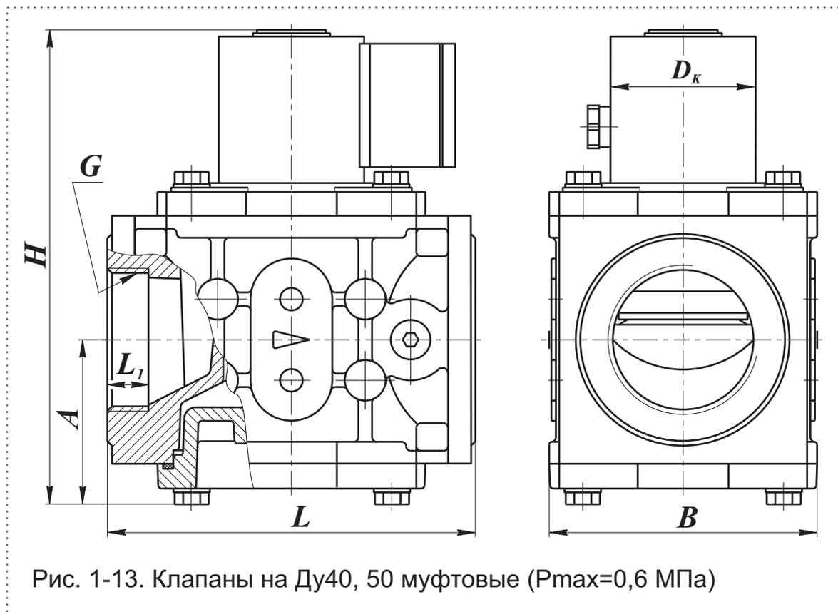
Рис. 1-13. Клапаны на Ду40, 50 муфтовые ( $P_{max}=0,6$  МПа)
