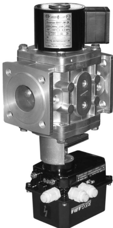
В конструкцию клапана встроена поворотная заслонка, при помощи которой осуществляется изменение количества пропускаемого газа через клапан. Конструктивно поворотная заслонка находится по ходу газа после запорного органа.
