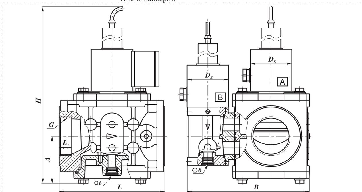
Рис. 3-12. Клапаны трехпозиционные муфтовые на Ду40, 50 с двумя регуляторами расхода и датчиками положения
