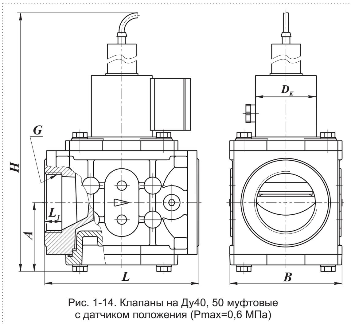
Рис. 1-14. Клапаны на Ду40, 50 муфтовые с датчиком положения ( $P_{max}=0,6$  МПа)
