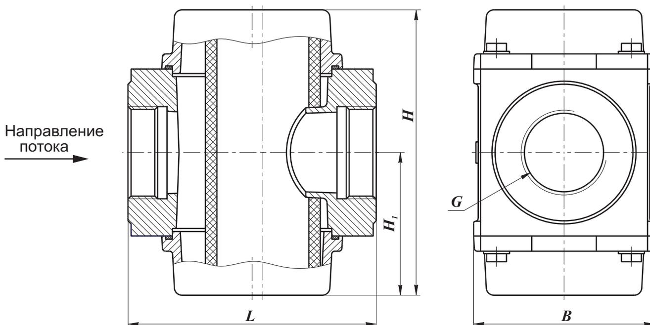
Рис. 5-4. Фильтры газовые муфтовые на Ду40, 50 (давление до 0,3 МПа)
