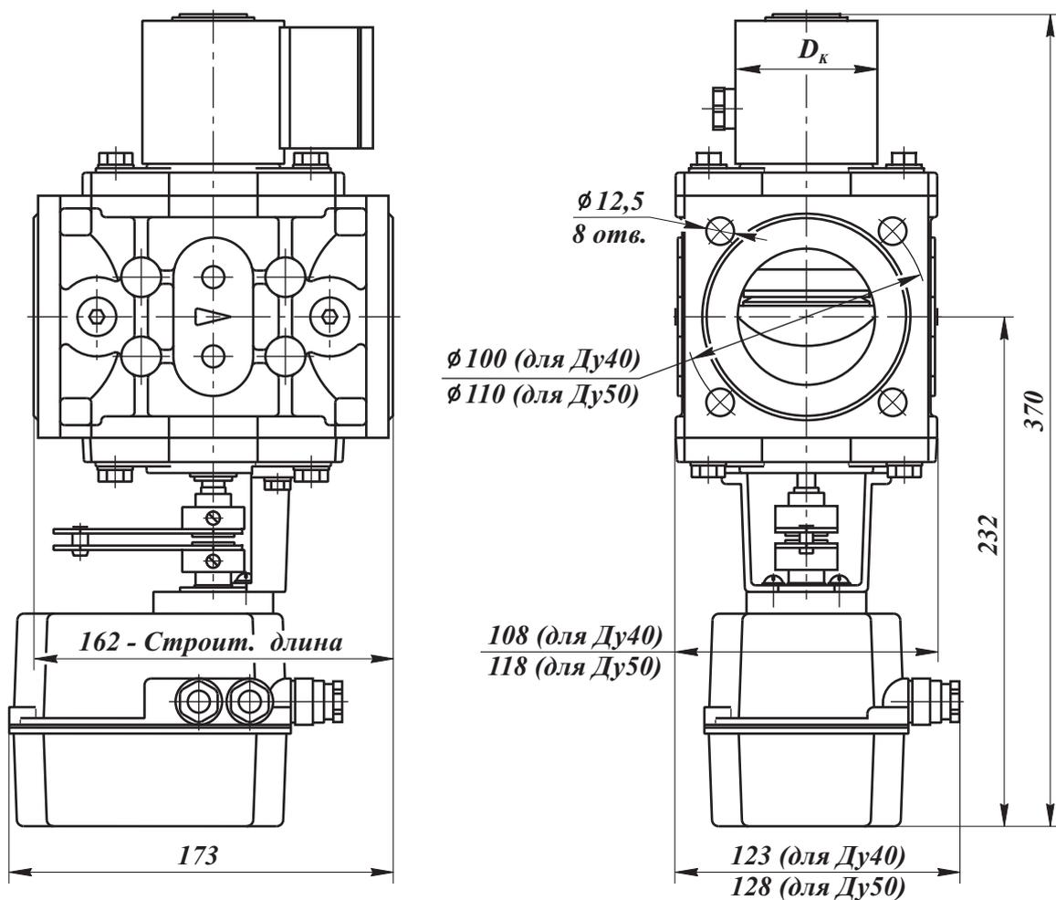
Рис. 2-6. Клапаны на Ду40, 50 фланцевые с электромеханическим регулятором расхода (пропорциональное регулирование, привод SP0)
