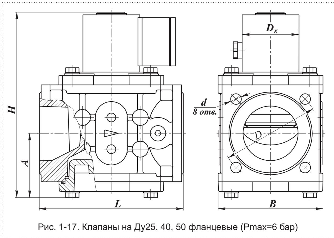
Рис. 1-17. Клапаны на Ду25, 40, 50 фланцевые (Pmax=6 бар)
