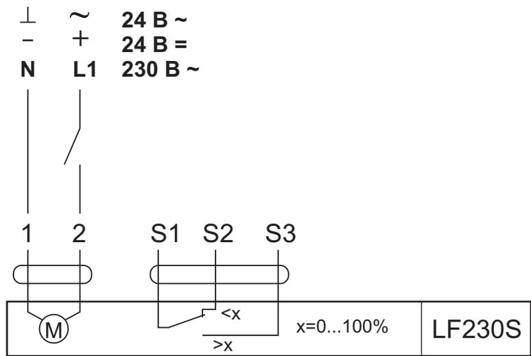
Рис. 2-3. Схема электрических соединений для электропривода LF230S (Швейцария)
