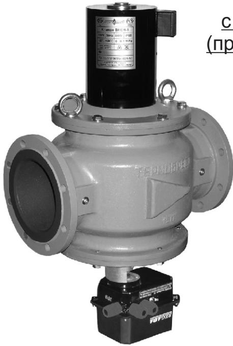
В конструкцию клапана встроена поворотная заслонка, при помощи которой осуществляется изменение количества пропускаемого газа через клапан. Конструктивно поворотная заслонка находится по ходу газа после запорного органа.
