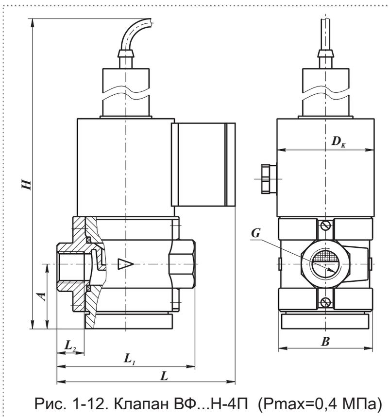
Рис. 1-12. Клапан ВФ...Н-4П (Pmax=0,4 МПа)
