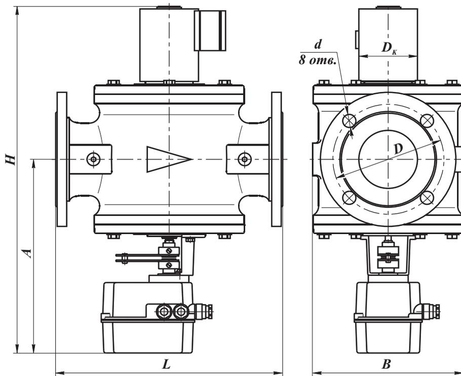
Рис. 7-4. Клапаны на Ду40, 50, 65, 80, 100 фланцевые в стальном корпусе с электромеханическим регулятором расхода (пропорциональное регулирование, привод SP0)
