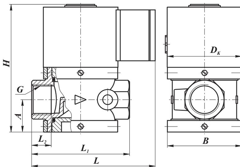
Рис. 4-1. Клапаны двухпозиционные муфтовые на Ду15, 20, 25
