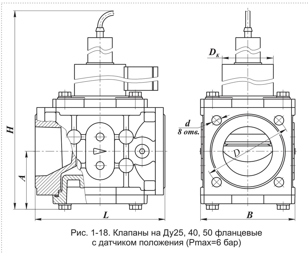
Рис. 1-18. Клапаны на Ду25, 40, 50 фланцевые с датчиком положения (Pmax=6 бар)
