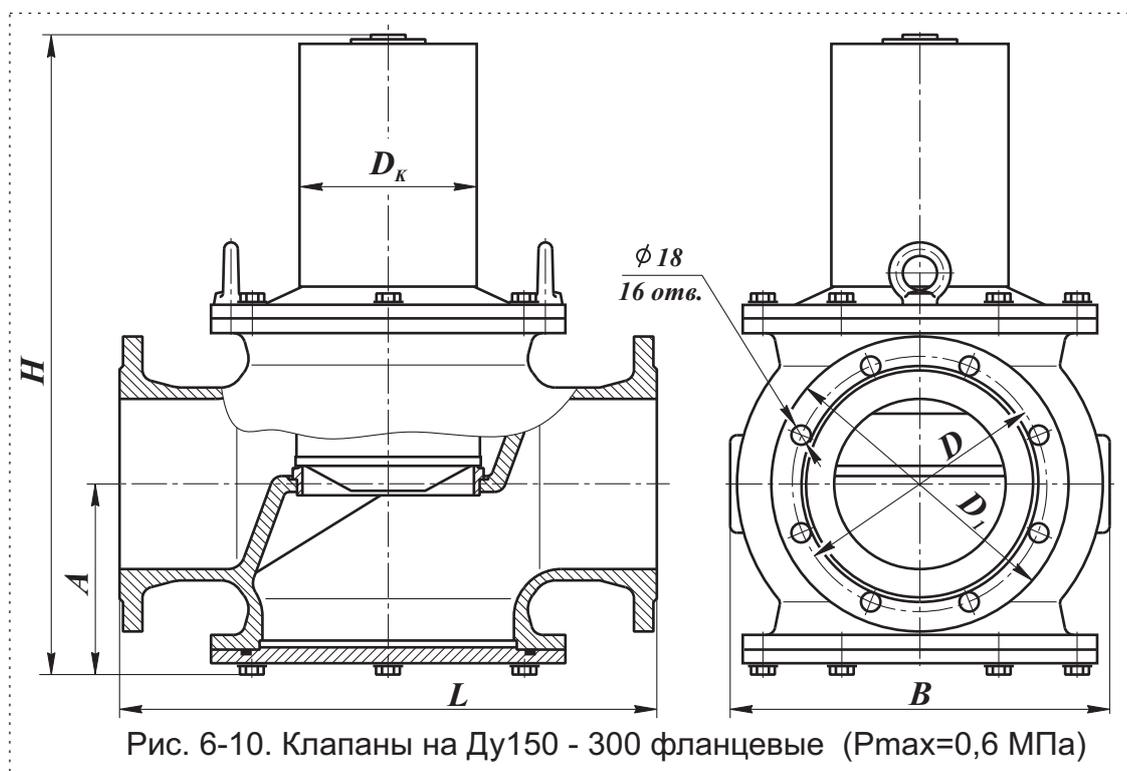
Рис. 6-10. Клапаны на Ду150 - 300 фланцевые (Pmax=0,6 МПа)
