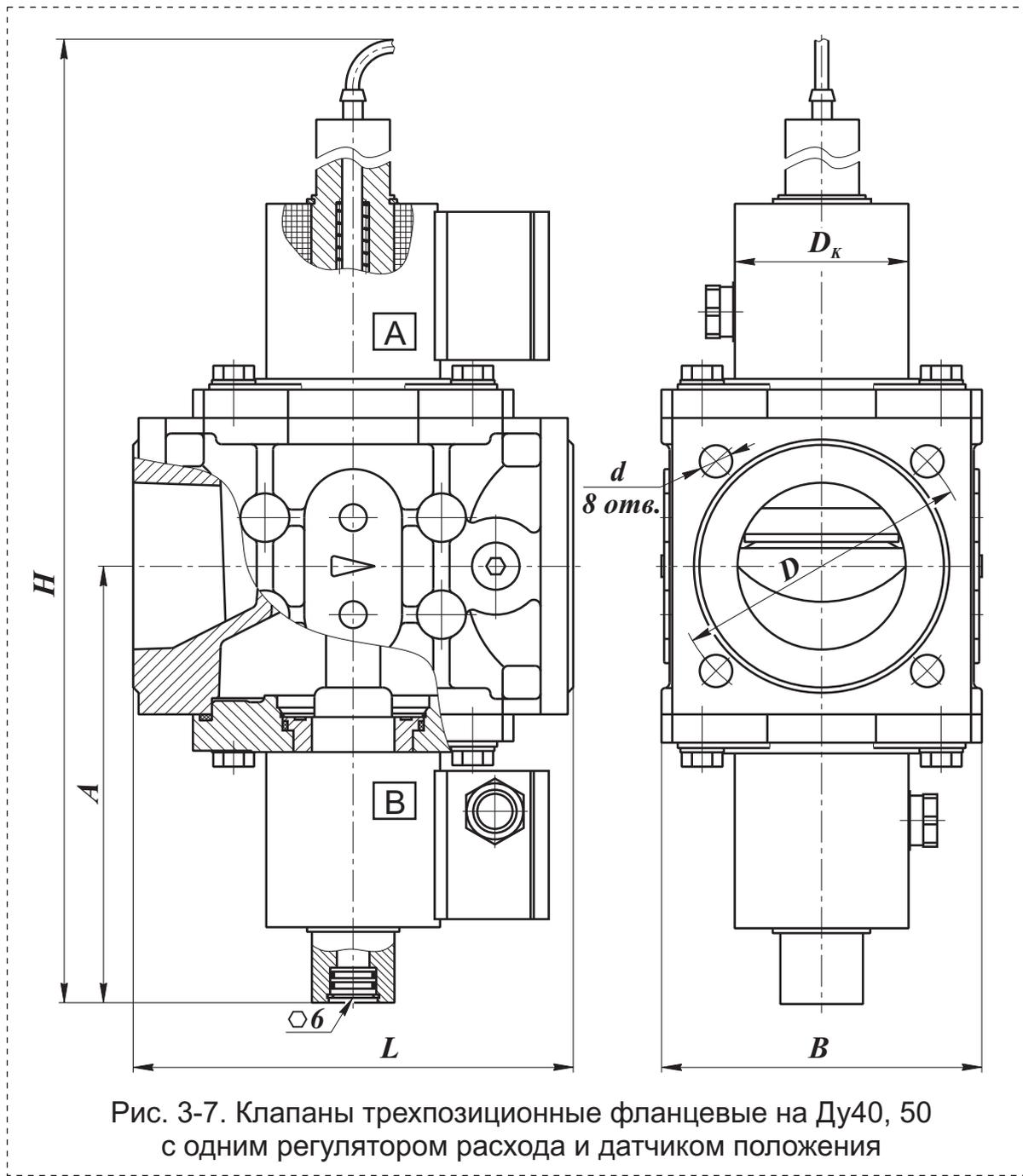
Рис. 3-7. Клапаны трехпозиционные фланцевые на Ду40, 50 с одним регулятором расхода и датчиком положения
