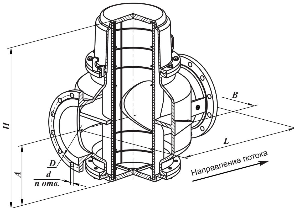
Рис. 9-2. Фильтры газовые фланцевые на Ду250, 300 мм
